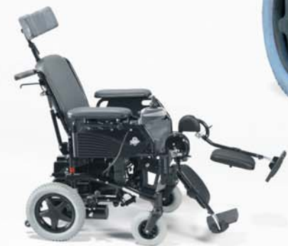
Wózek Rapido wyposażony w opcje dodatkowe: zagłówek, odchylane oparcie, regulowane podnóżki.
